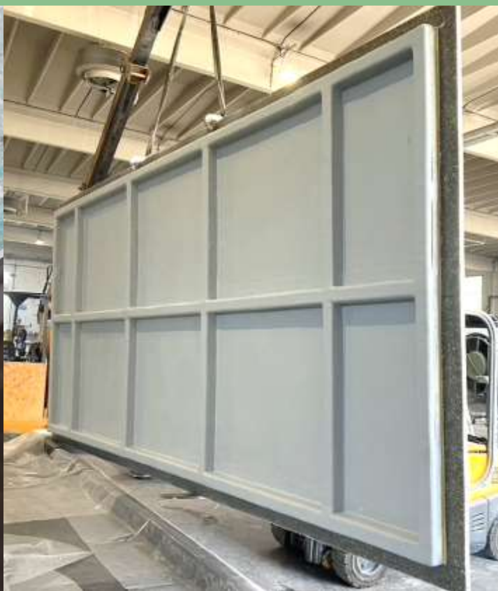
In questo shelter da 20 ft realizzato nell'ambito del progetto MAELSTROM (Horizon 2020) sono stati prodotti pannelli sandwich con rinforzi e lastre Recomplax D'ecò abbinate a espansi rigidi EPS / In this 20 ft shelter created as part of the MAELSTROM project (Horizon 2020), sandwich panels were produced with Recomplax D'ecò reinforcements and sheets combined with EPS rigid foams
