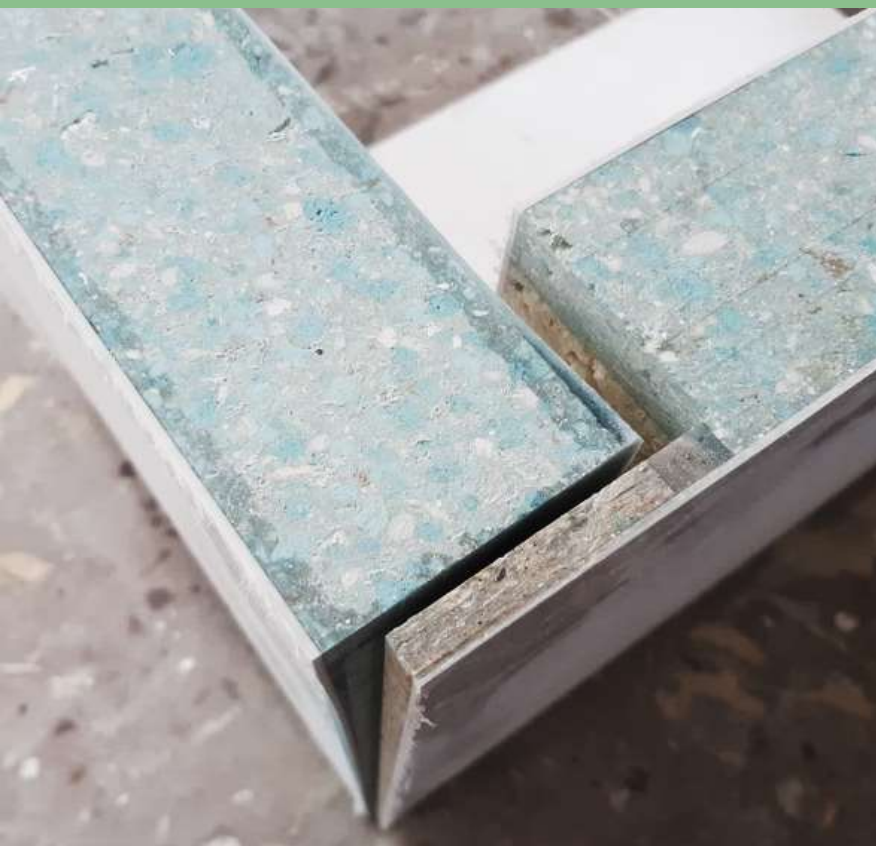
In questo shelter da 20 ft realizzato nell'ambito del progetto MAELSTROM (Horizon 2020) sono stati prodotti pannelli sandwich con rinforzi e lastre Recomplax D'ecò abbinate a espansi rigidi EPS / In this 20 ft shelter created as part of the MAELSTROM project (Horizon 2020), sandwich panels were produced with Recomplax D'ecò reinforcements and sheets combined with EPS rigid foams
