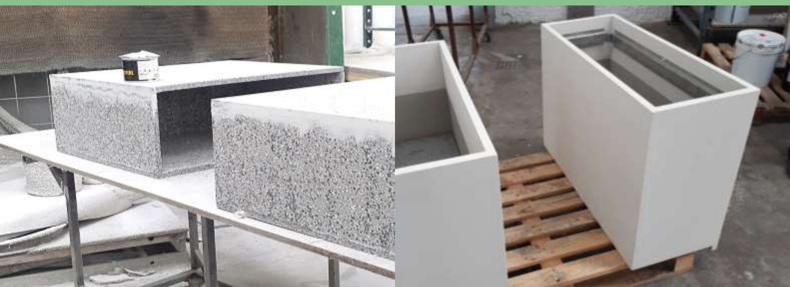
Fioriera parapetto per balconata di edificio residenziale. Costruzione su misura in Recomplax Basic e finitura in resina bicomponente / Parapet planter for balcony of residential building. Customized construction in Recomplax Basic and two-component resin finish
